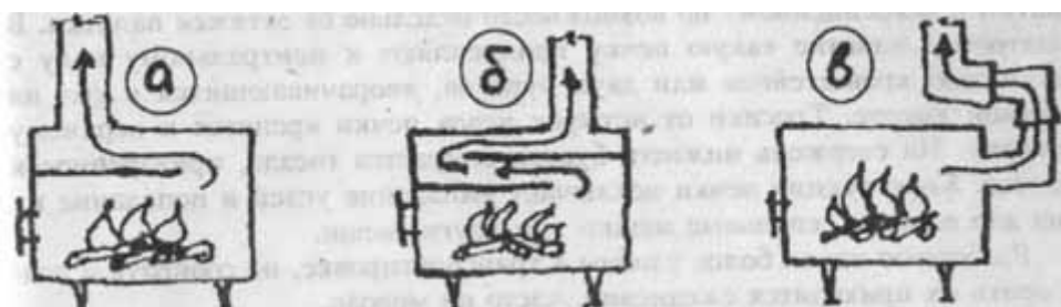
Рис. 49. Схемы изменения направления горячих газов походных печек:
